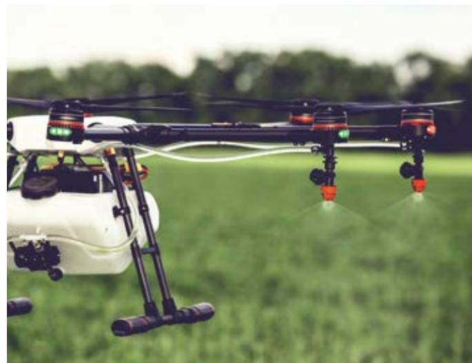
Установка навигационного модуля высокой точности на борт агродрона позволит производить опрыскивание участков без пропусков и переобработки.
