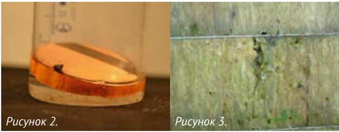
*Рисунок 2. Образец плит полистирольных вспененных экструзионных (XPS), инокулированный микробным сообществом в жидкой органо-минеральной питательной среде. Локализация микроорганизмов (одиночные микроколони) формируются на границе раздела сред, тогда как поверхность материала оказалась чистой. Биопленка образуется на дне сосуда, но не на поверхности материала.*
