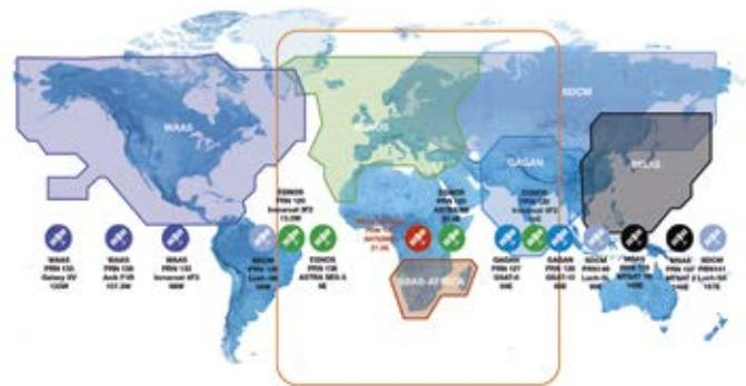
WAAS, EGNOS, СДКМ, MSAS, GAGAN – вот основные системы диф. коррекции, позволяющие обеспечить субметровую точность определения координат бесплатно на определенной территории.
