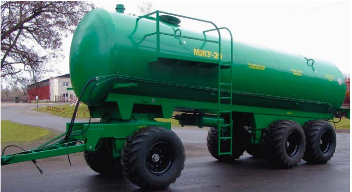
Машина имеет несложную конструкцию - емкость объемом 20 м<sup>3</sup> установлена на прицепном трехосном шасси. Заполнение емкости водой осуществляется от внешнего источника через верхний люк, выгрузка - самотеком или с помощью насоса, оснащенного гидромотором.
