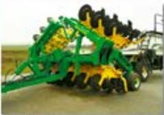
Агрегат полосовой обработки почвы (Strip-Till) "Орлик"
