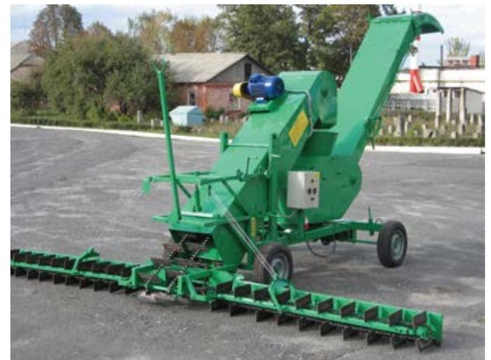
Показатели качества работы погрузчиков при вышеуказанных производительностях удовлетворяли требованиям ТУ. По ПЗЭС-200 при высоте погрузки равной 4,3 м полнота подбора зерна составила 99,8 процента при допустимых по ТУ показателях не менее 99,5 процента. У погрузчика ПЗН-250 при высоте погрузки 3,7 м полнота подбора была равна 99,87 процента, что также находится в пределах требований. Дробление зерна транспортирующими органами машин составило 0,13 и 0,15 процента соответственно.
