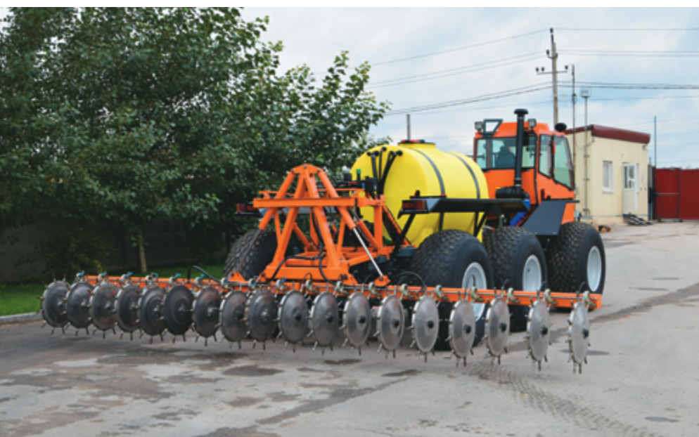
Мультиинжектор ТУМАН 2 - 2М (точечное внесение удобрений)
