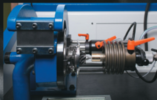
БАЛАНСИРОВОЧНЫЙ СТАНОК СМТ-48 VSR
