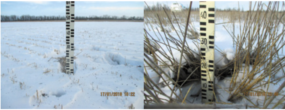
Рисунок 3. – Глубина снежного покрова при уборке на высоте 5-6 см (слева) и методом очёса растений
