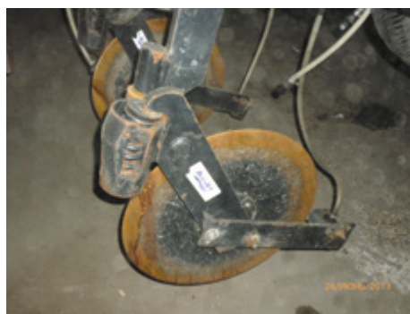
Рисунок 1. – Дисковый рабочий орган (слева) и агрегат Ликвилайзер для внесения жидких удобрений с заделкой в почву
