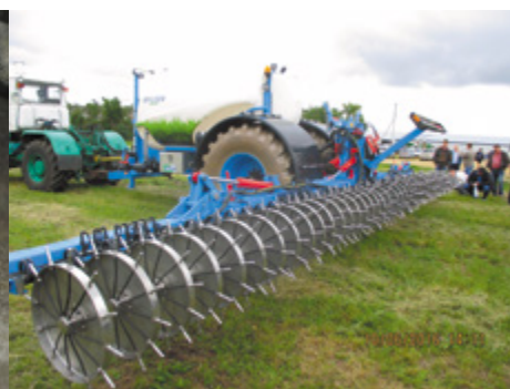
Рисунок 1. – Дисковый рабочий орган (слева) и агрегат Ликвилайзер для внесения жидких удобрений с заделкой в почву
